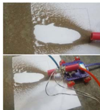
شکل (۲). عملکرد ربات سندبلاست در فشار ۰/۵bar
