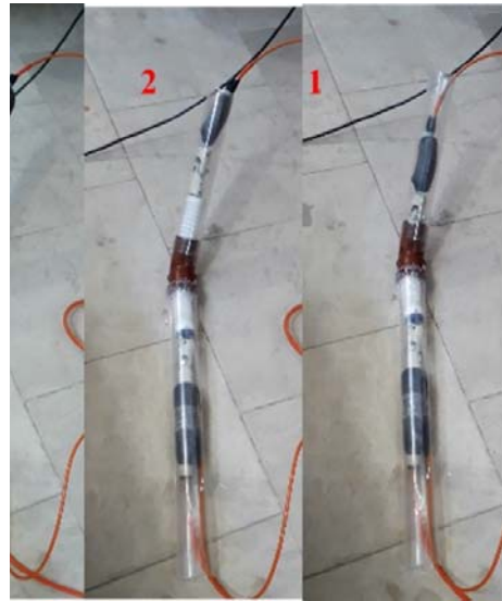
شکل (۹). حرکت ربات درون لوله با زانویی 45^\circ درجه و زاویه نسبت به خط افق (الف) در آستانه ورود به زانویی (ب) پیشروی در زانویی (ج) پیشروی در زانویی و حرکت در مسیر قائم
