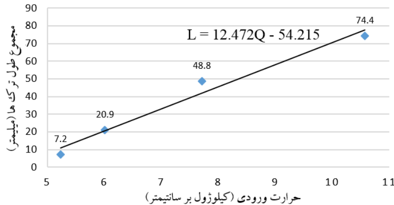
شکل (۶). نمودار مجموع طول ترک‌های گرم بر حسب حرارت ورودی
