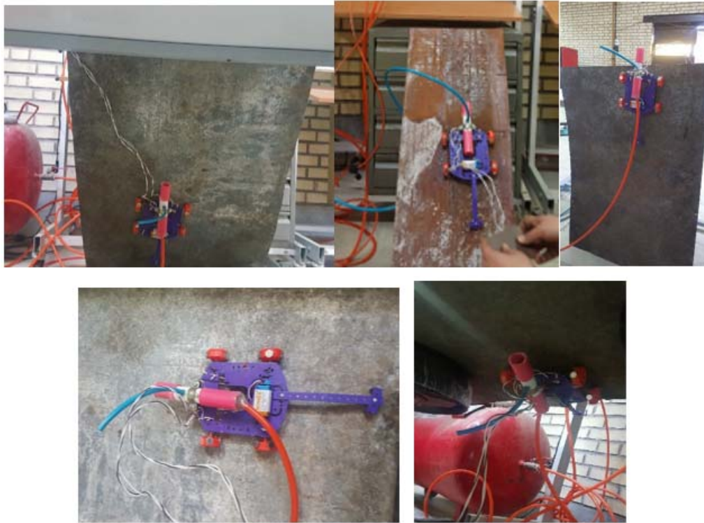
شکل (۲). ربات بالارونده سندبلاست در زوایای مختلف
